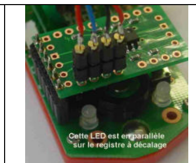
Le connecteur femelle est soudé au Bimo
